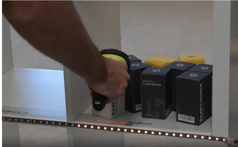
Figura 15. Detall de la graella amb una casella il·luminada (put-to-light) indicant on s'ha de col·locar el producte escanejat Nota. Fotografia pròpia.
