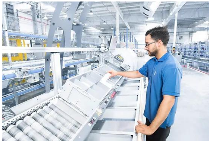
Figura 10. Arquitectura industrial estàndard de put-to-light. Nota. Elaboració pròpia a partir de documentació tècnica de Banner Engineering, SSI Schäfer i Knapp ( https://www.bannerengineering.com/ ; https://www.ssi-schaefer.com/ ; https://www.knapp.com/ ).
